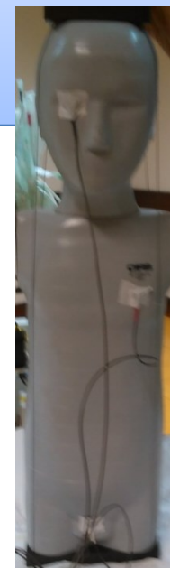
Fig. 2- Fantoma ATOM-705-CIRS. Fantoma com os detetores colocados nos órgãos radiosensíveis..
