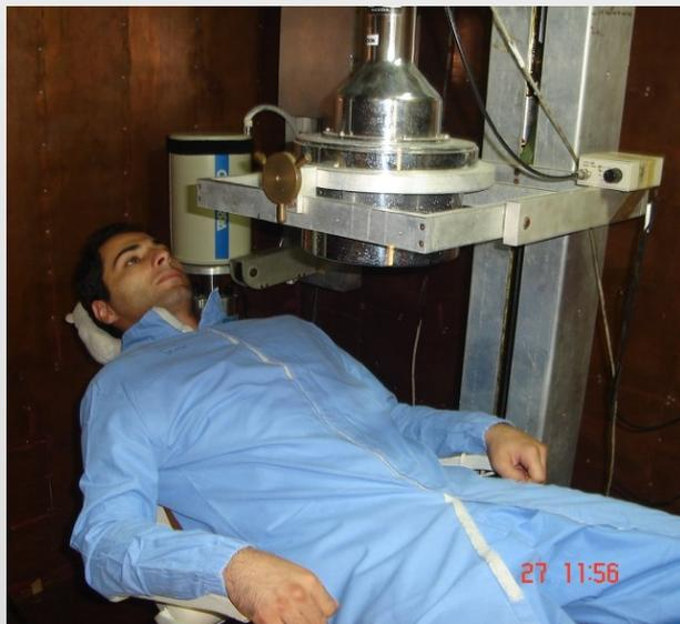
Laboratório de Monitoração In Vivo (LABMIV) do IRD, possui disponíveis sistemas de detecção específicos para a identificação e quantificação de radionuclídeos emissores gama na faixa de energia de 10 a 3000 keV
